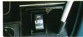
〈LPGスイッチ・鉛筆たて〉LPGのスイッチを計器盤の右下に、そして、日報などの記入に便利な鉛筆たても、その横に装備しました。
