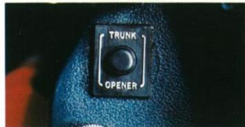
〈電磁式トランクオープナー〉スイッチに軽くタッチするだけで運転席からトランクを開けられます。デラックスに標準装備。(デラックスA、スタンダードはケンブル式が注文装備)
