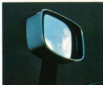
〈電動リモコン式フェンダーミラー〉運転席から左右のフェンダーミラーを操作できます。電動式ですから、操作ノブを軽く上下左右に動かすだけで、正確かつスピーディに視界調節ができます。デラックスに注文装備です。
