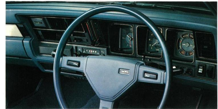
風格のただよう、見やすい計器盤(ダッシュボード) 銀色に緑どりされた角型3連メーターには、左から3針式時計、スピードメーター、各種ゲージ類が見やすく配置されています。ハイヤーとして、個人タクシーとして、心からご満足いただける豪華な雰囲気をかもし出します。
