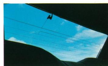
〈熱線式リヤウインドウ・デフォグガー兼用AMアンテナ〉リヤの熱線をAMラジオのアンテナとして使用する新しいアイデアです。ノイズをすくなくすることができ、美しい音楽をお楽しみいただけます。(デラックス)
