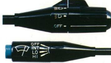
〈集中一体式スイッチ〉手をほんのすこし伸ばすだけで各装置を操作できる便利で安全な機構です。運転中に必要な各種のスイッチ類をステアリングコラム上の2本のレバーに集めて、操作を手軽で正確なものにしました。
